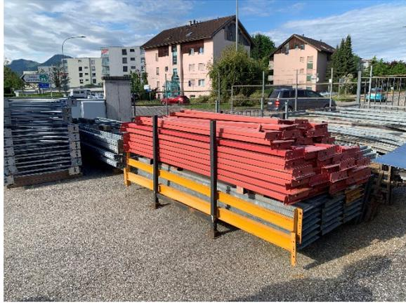
*Figure 32 Traverses des racks à palettes ©He-Arc CR, Jasmine Praz, 2024*
